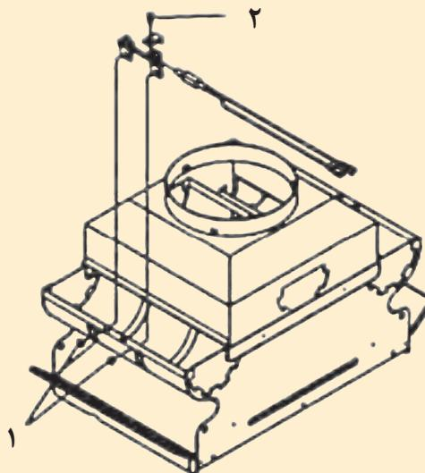
**نحوه تست ترموستات دود:** دردماهی پایین‌تر از  $75^{\circ}\text{C}$  با اهم‌تر مدار آن را چک می‌کنیم که باید بسته باشد.
