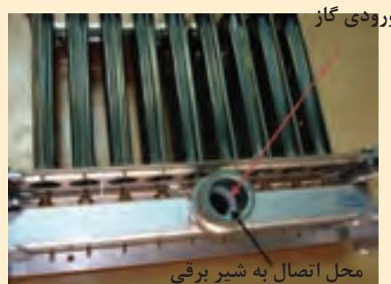
با باز کردن پیچ ها درب محفظه احتراق را باز نمایید. الکترود جرقه زن و حسگر حضور شعله را جدا نمایید. با شل کردن مهره اتصال شیر گاز به مشعل را باز نمایید. پیچ نگهدارنده مشعل به چند راهه را باز نمایید. پیچ های نگهدارنده مشعل را باز نمایید. مشعل را از جای خودش خارج نمایید.
